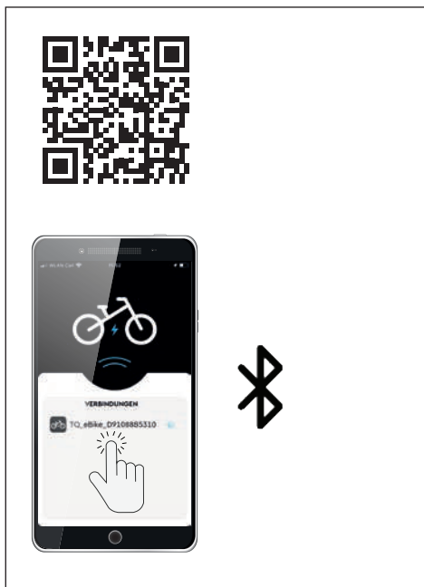
Fig. 5: Conexión E-Bike a Smartphone
