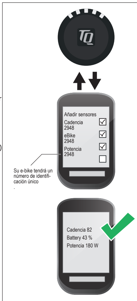
Fig. 6: Conexión de la e-bike al ciclocomputador
