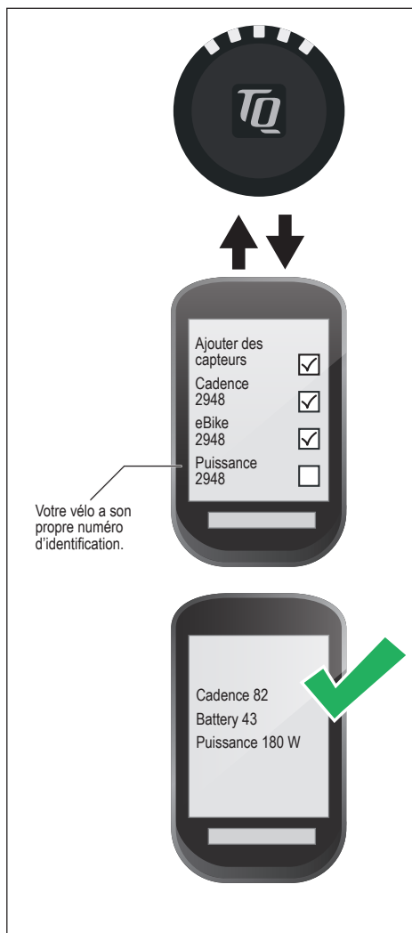
Fig. 6: Connexion entre le E-Bike et le compteur vélo
