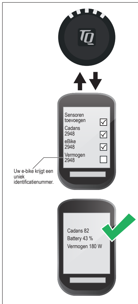
Fig. 6: Verbinding e-bike met fietscomputer
