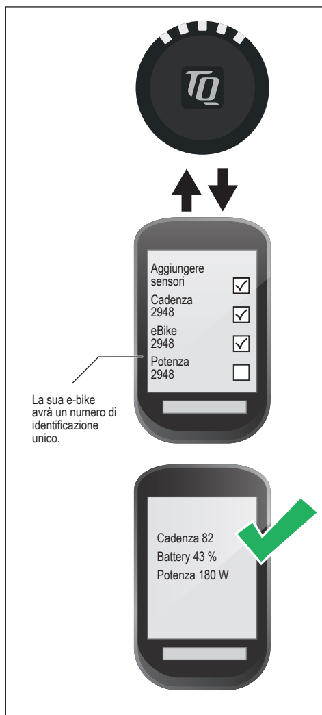
Fig. 6: Collegamento e-bike al computer da bicicletta
